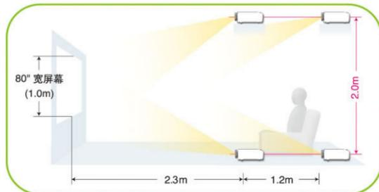
通过变焦能够前后移动投影机扩大投射范围。只需2.3米就能投射80英寸的大画面。
